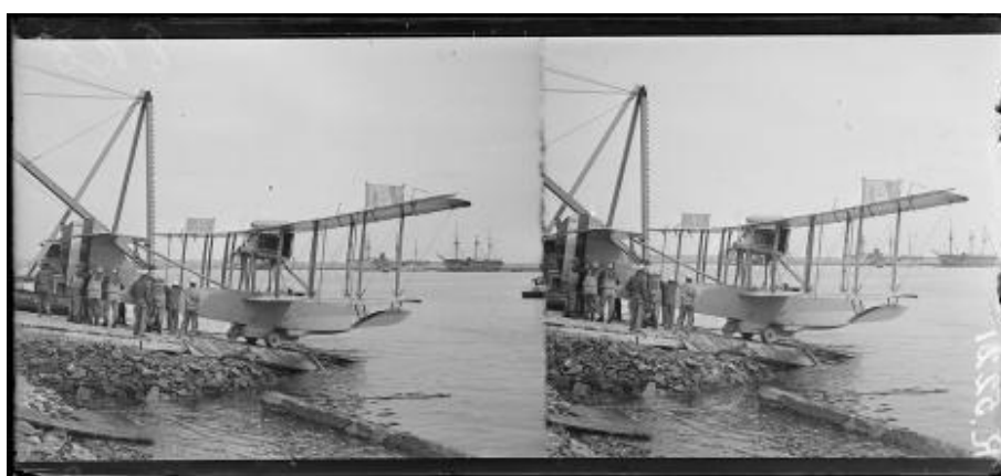
Référence : SPA 153 R 5221 Brest, stations américaines d'hydravions de Laninon. Mise à l'eau d'un appareil. Des appareils de la base de Brest-Laninon assurent la surveillance de la rade et des convois de ravitaillement arrivant des États-Unis. Un hydravion Curtiss HS-2L est manoeuvré pour être mis à l'eau. 30 septembre 1918. Photographe : Edmond Famechon/© ECPAD
